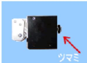
ツマミを反時計方向に回し、上下ローラーの間隔を広げます。
